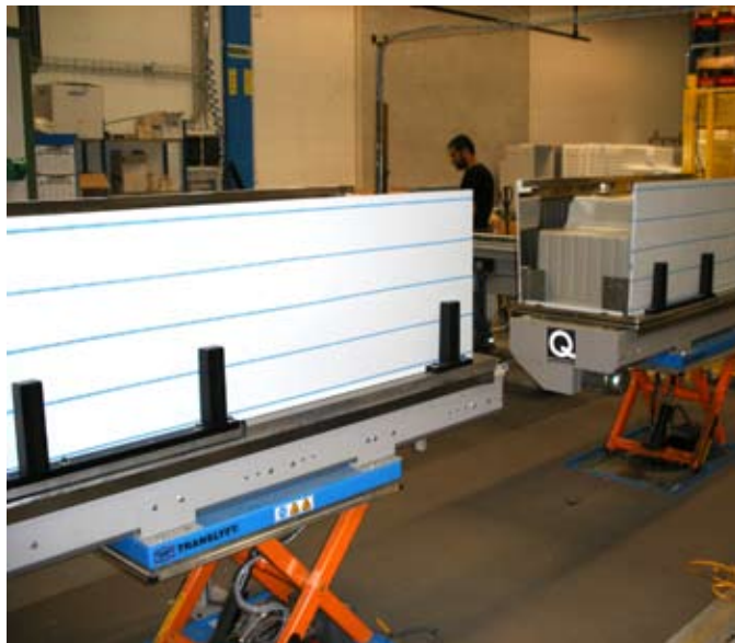
Montagen af køleskabenes foregår på individuelt tilpassede løfteborde, så montagemedarbejderen altid har den rette arbejds højde.
