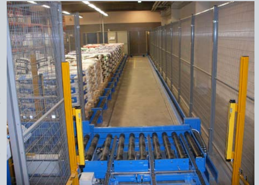
Transfervognen står parat til at modtage en ny palle til indføddning i anlægget.
